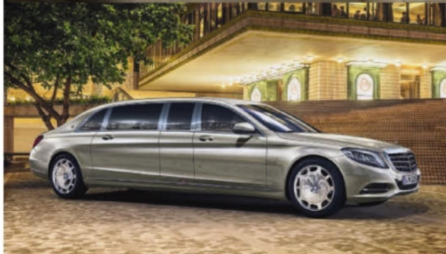
Le compartiment arrière allongé a été dessiné et configuré autour de quatre passagers installés en vis-à-vis. L'empattement de la Pullman dépasse 4,40 mètres et sa longueur tutoie 6,50 mètres.
